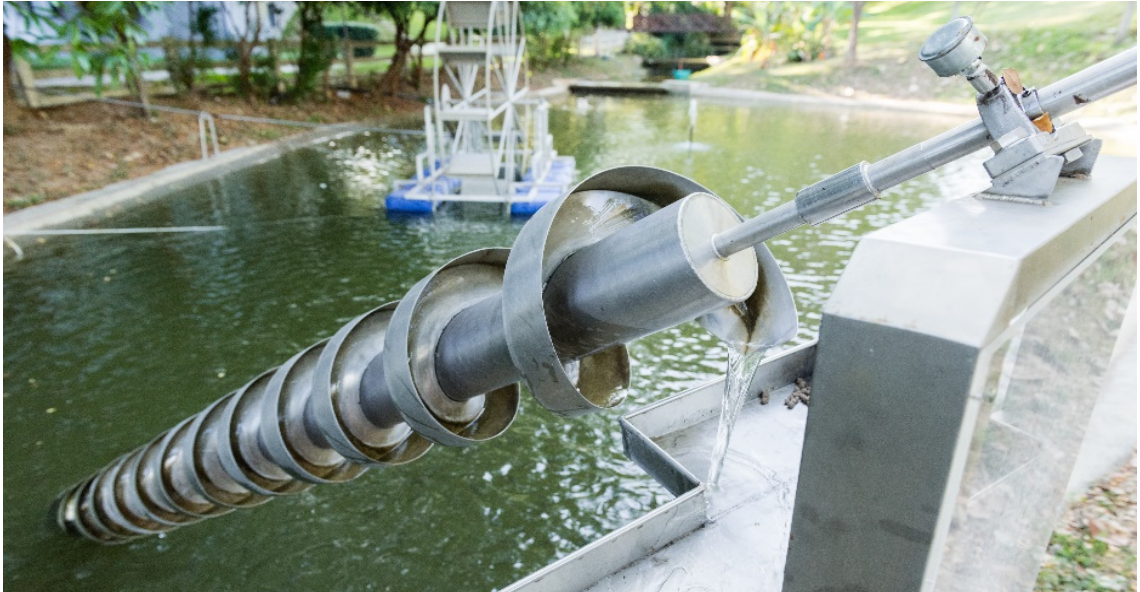
圖 1-2 公園裏的阿基米德泵抽水系統
