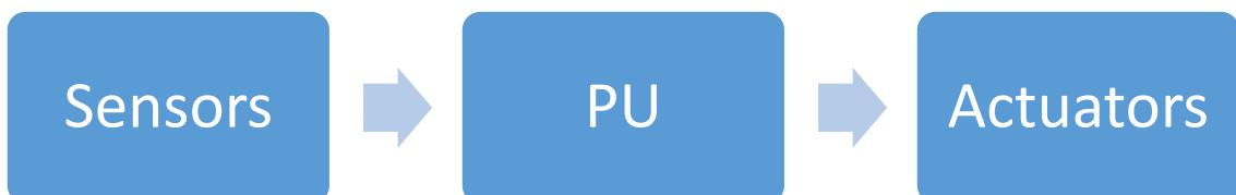
感測器(Sensor)產生訊號是輸入，傳動器(Actuators)接收訊號輸出聲音、光、熱、動力。感測器連接方式有 SVG、I2C、SPI。
